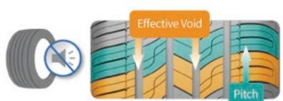
ピッチ数やパターン配列の最適化によりノイズ発生を抑制。内部パーツの見直しにより乗り心地も向上。
